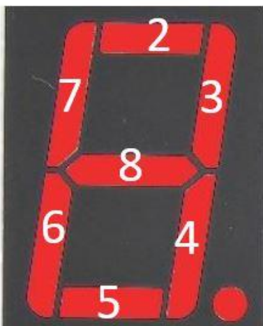
Figura 2: portas digitais conectadas no display
